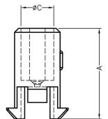
用途:可快速将LED固定于机器面板上
