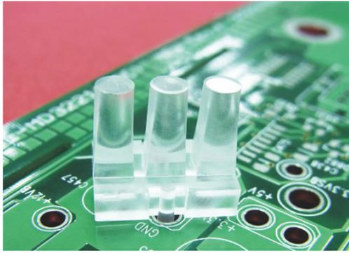
用途：使S.M.T LED导光于机壳面板上，使光度均匀、柔和。
